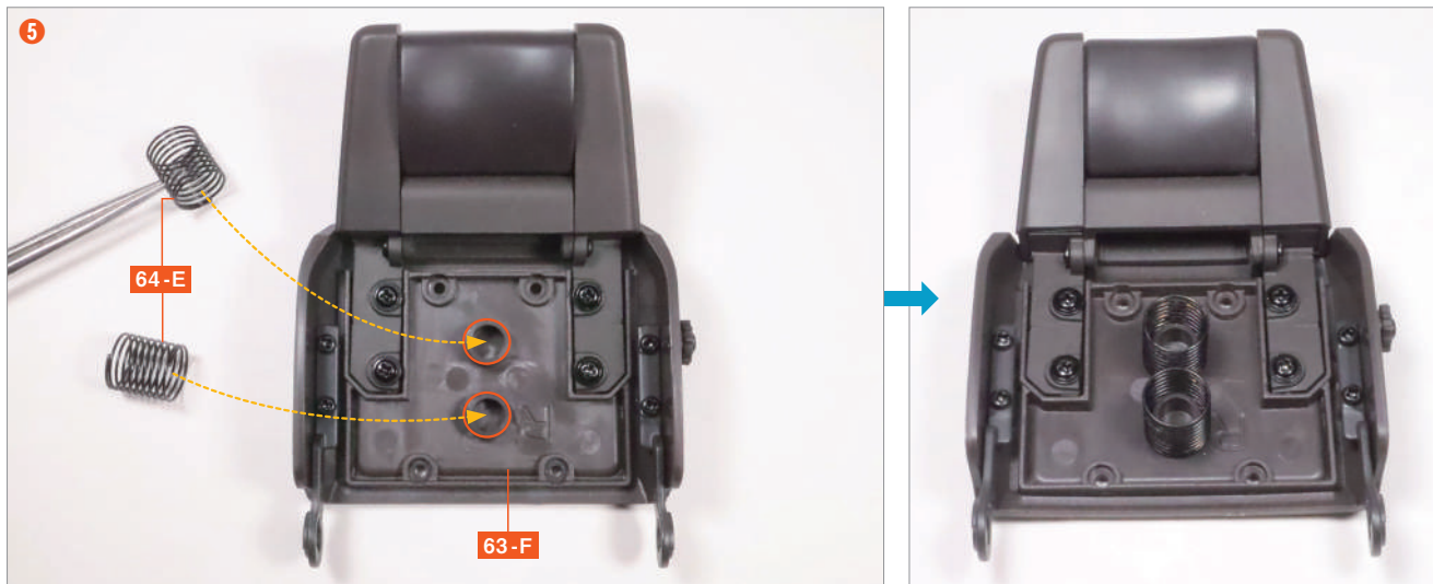
將兩個彈簧 64-E 分別插入 63-F 上的兩個圓形突起部分中。
